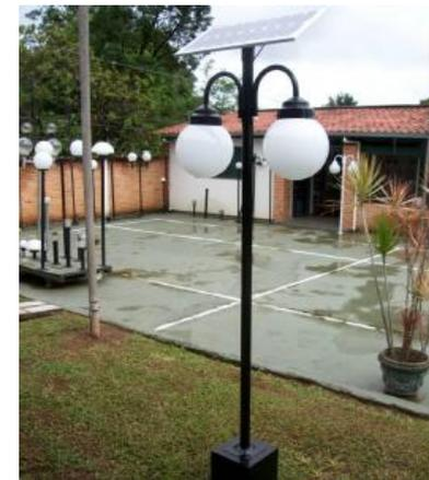
Postes de iluminação fotovoltaico serão instalados postes de energia solar, desenvolvidos para serem independentes, sustentáveis e duradouros. Eles não dependem de rede elétrica, necessita de pouca manutenção e simples instalação.
