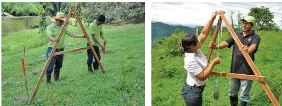
Figura 13 - Exemplos de marcação de curva de nível com utilização de pé-de-galinha (FHIA, 2011).
